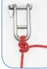
Der Roringstek wird treffenderweise auch Ankerstek oder Fischerstek genannt, denn es gibt keine bessere Möglichkeit, um ein Tau an einem Anker zu befestigen. Statt des halben Schlages kann zum Schluss auch ein
