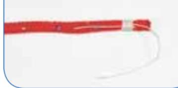
Der Takling ist immer noch die beste Art, einen Tampen vor dem Ausfransen zu sichern. Andere Methoden (Tape, abbrennen) sind weniger dauerhaft oder nur speziell anwendbar. Der Takling kann dagegen bei allen Tau-
