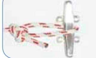
Der Palstek ist unbestritten einer der sichersten Knoten zum Festmachen, auch wenn schnell Last auf die Leine kommt. Bis zu Bild 2 kann alles an Bord
