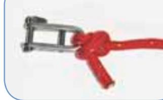
Der Gordingstek wird zum Anstecken von Leinen an Beschlägen, Ösen und Kauschen verwendet. Der größte Vorteil ist seine Kürze. Der Schäkel kann dicht an die Rolle im Masttopp gezogen werden, das Schothorn nahe an den Holepunkt. Letzteres ist allerdings nur bei tiefgeschnittenen Segeln von
