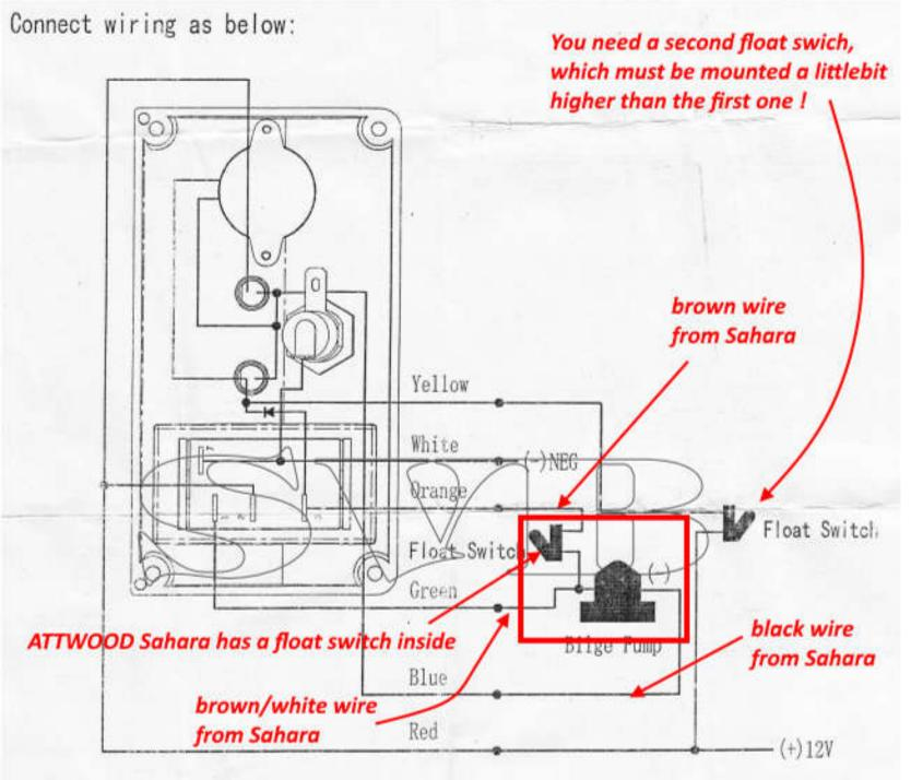
Use min. 16 AWG Cable / min. 1,5 mm<sup>2</sup> wire cross section
