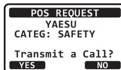
7. Si le **GX1300E** ne reçoit pas une réponse, l'affichage sera semblable à celui illustré dans la figure à droite. Pour émettre à nouveau, appuyez sur la touche **RESEND**.
