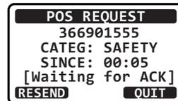
11. Lorsque le **GX1300E** reçoit la position du navire interrogé, le **GX1300E** émet une sonnerie d'alarme et la position du navire interrogé est émise à un traceur de cartes GPS par l'intermédiaire de NMEA 0183. (DSC BEEP doit être activé pour entendre l'alarme.)
