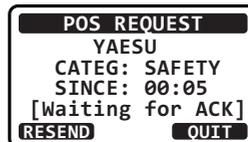
8. Lorsque le **GX1300E** reçoit la position du navire interrogé, le **GX1300E** émet une sonnerie d'alarme et la position du navire interrogé est émise à un traceur de cartes GPS par l'intermédiaire de NMEA 0183. (DSC BEEP doit être activé pour entendre l'alarme.)
