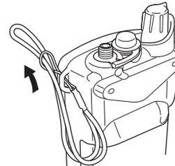
Handschlaufe durch die Öse an der oberen Ecke des Funkgeräts ziehen, wie links gezeigt. Die Handschlaufe ist zum Tragen des Funkgeräts vorgesehen.
