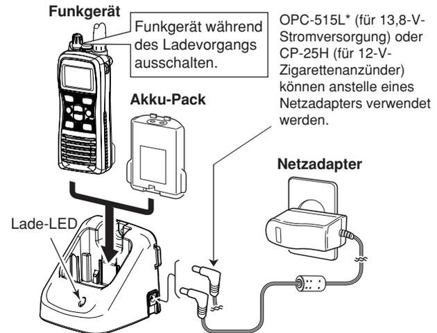
**ACHTUNG:** Bei Benutzung eines OPC-515L **NIE** die Polarität des Kabels verwechseln. Dies würde das Ladegerät zerstören.
