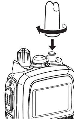
Schließen Sie die flexible Antenne an den Antennenanschluss an.
