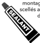
Tous les orifices de montage doivent être scellés avec un produit d'étanchéité de qualité marine pour éviter la pénétration de l'eau.
