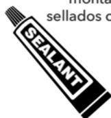
Todos los orificios de montaje deben estar sellados con un sellador apto para aplicaciones marinas para evitar la intrusión de agua.
