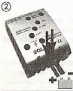
Schließen Sie die Zuleitungen zur Batterie polrichtig an. Um spannungsfrei zu arbeiten, schließen Sie die Kabel zuerst an den Regler, dann an die Batterie an. Achten Sie auf die Zuleitungslänge (mind. 30 bis max. 100 cm) und die Kabelquerschnitte: mind 4 mm<sup>2</sup>. Verpoltter Anschluss wird akustisch signalisiert.
