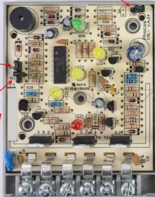
**Einstellung mittels Steckbrücken (Jumper),
