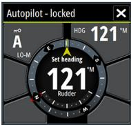
Cuando la función de bloqueo remoto se activa en una unidad AP24/AP28 de control, solo se puede controlar la unidad de control activa. No es posible controlar la unidad Vulcan ni otras unidades de control de piloto automático del sistema.
