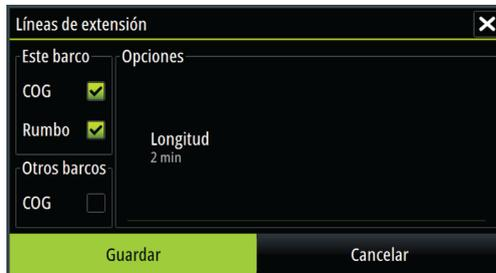
La información de rumbo de la embarcación se obtiene del sensor de rumbo activo, y la información COG, del sensor GPS activo.
