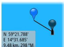
El cursor puede usarse para medir la distancia entre la embarcación y una determinada posición, o entre 2 puntos del panel de carta.
