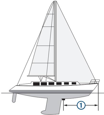
2 Depuis une vue du sondeur proposant cette option, sélectionnez **Menu > Réglages du sondeur > Installation > Décal. d'étrave**.
