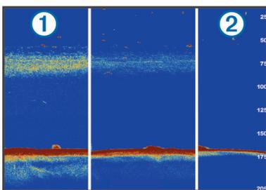
Vous pouvez utiliser conjointement l'étirement d'écho et la largeur du filtre afin d'atteindre une résolution et une réduction du bruit optimales. Lorsque les valeurs de l'étirement d'écho et de la largeur de filtre sont basses,
