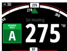
Nella modalità AUTO il sistema autopilota invia al timone i comandi necessari per il governo automatico dell'imbarcazione in una direzione stabilita. In questa modalità l'autopilota non esegue alcuna compensazione per l'eventuale scarroccio causato dalla corrente e/o dal vento (**A**).
