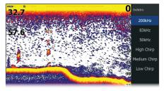
→ *Nota:* Le frequenze dello StructureScan® (800kHz e 455 kHz) vengono selezionate tramite la pagina frequenze nel menu Struttura.
