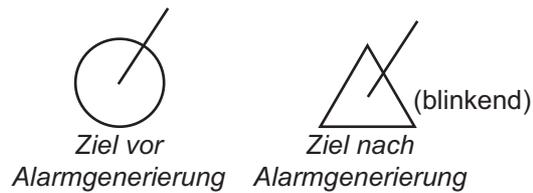
Diese Funktion hilft bei der Erkennung von Zielen, die sich möglicherweise auf Kollisionskurs befinden. Verstärkung, See-Echos und Regen-Echos korrekt anpassen.
