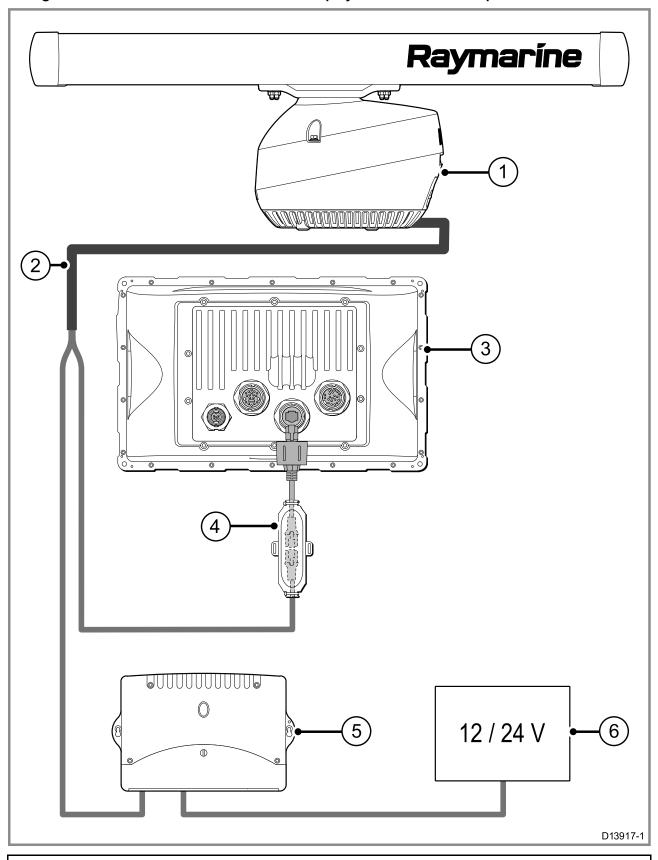
**Nota:** Alcuni collegamenti all'alimentazione sono omessi in questa immagine. Il display multifunzione deve avere una collegamento dell'alimentazione separato.
