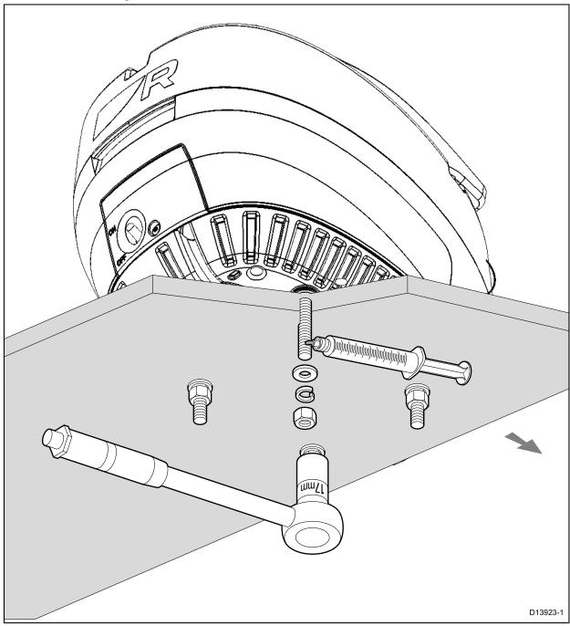
12. Utilizzare tutti e quattro i bulloni e le rondelle per fissare la base alla superficie di montaggio. La lunghezza in eccesso dei bulloni non deve superare i 6 mm. Se necessario, accorciare i bulloni.
