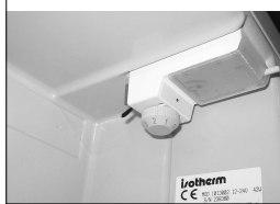
Plaatsing thermostaat CR 130 Drink, in verlichtingsarmatuur.
