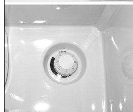
Plaatsing thermostaat in CR 65, op achterwand rechts van het koelvak.
