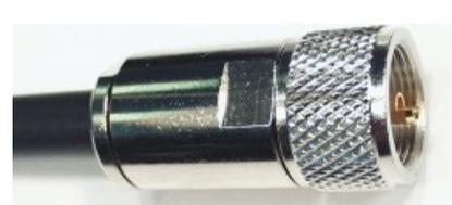
Das so vorbereitete Kabelende bis zum Anschlag in das Steckergehäuse einschieben. Mit zwei Maulschlüsseln 17 mm und 18 mm die Spannmutter handfest anziehen. Ein kleiner Spalt zwischen Mutter und Steckergehäuse sollte noch sichtbar sein!
