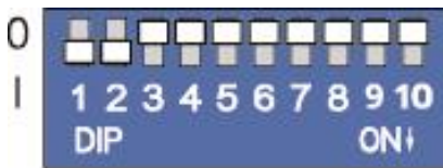
Figure 4 : Commutateurs DIP (réglages usine)
