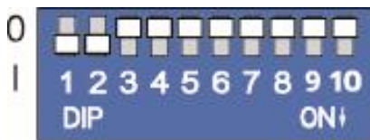
Figura 4: Conmutadores DIP (ajustes fábrica)
