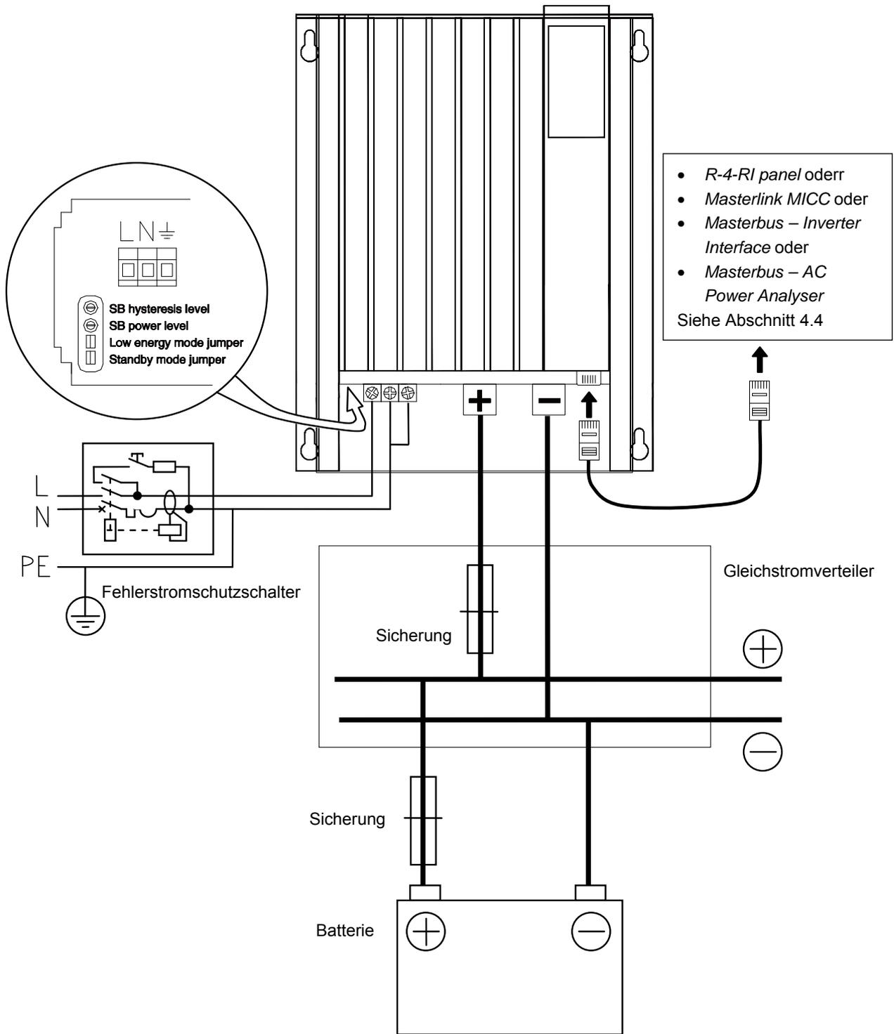
Diese schematische Darstellung zeigt die allgemeine Platzierung des Mass Sine in einem Stromkreis an. Es ist hiermit nicht beabsichtigt, detaillierte Verkabelungsanweisungen für eine bestimmte elektrische Installation zu geben.
