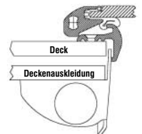
Querschnitt durch Rollo/Fliegengitter.
