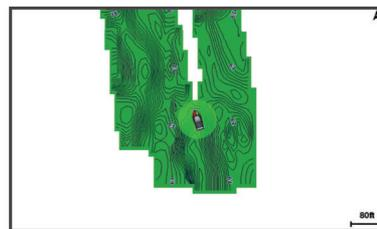
Un cerchio verde indica una buona profondità e posizione GPS e una velocità inferiore a 16 km/h (10 mph). Un cerchio giallo indica una buona profondità e posizione GPS e una velocità compresa tra 16 km/h (10 mph) e 32 km/h (20 mph). Un cerchio rosso indica una bassa profondità o posizione GPS e una velocità superiore a 32 km/h (20 mph).
