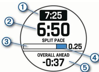
Il dispositivo visualizza l'andatura obiettivo del tempo intermedio ①, l'andatura corrente del tempo intermedio ②, lo stato di avanzamento del tempo intermedio ③, la distanza rimanente nel tempo intermedio ④ e il tempo complessivo superiore o inferiore all'andatura obiettivo ⑤.
