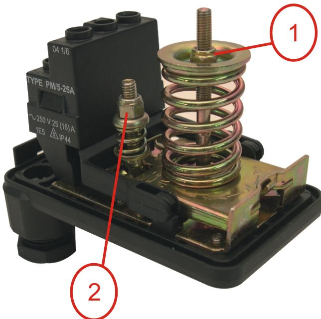
**MODALITA' DI TARATURA.** Per modificare la taratura standard di fabbrica bisogna operare sul dado rif.(1) per variare la pressione di avvio della pompa (minimo 1,8 bar) e sul dado rif.(2) per variare la pressione di stacco della pompa (max 5,0 bar). Avvitando il dado di regolazione in senso orario si incrementano i valori di taratura. Non operare al di fuori di questi due campi di intervento.
