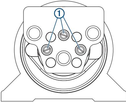
2 Pour désactiver les vannes d'arrêt, desserrez complètement les vis des vannes.
