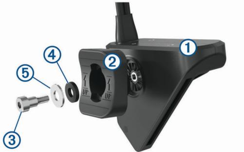
2 À l'aide de la clé Allen fournie, fixez le support à la sonde avec la vis à épaulement ③, la rondelle en caoutchouc ④ et la rondelle plate ⑤.
