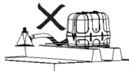
Abbildung 10. Die Auspuffschläuche vom Generator zum Wassersammler dürfen nur abwärts verlaufen
