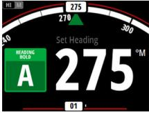
Im AUTO-Modus gibt der Autopilot die erforderlichen Ruderbefehle aus, um das Schiff automatisch auf einem festgelegten Kurs zu halten. In diesem Modus führt der Autopilot keinen Ausgleich infolge des Abdriftens durch Strömung und/oder Wind (**A**) durch.
