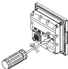
Das AP44 verfügt über einen integrierten USB-Anschluss auf der Rückseite des Gerätes. Für Softwareaktualisierungen verwenden Sie diese Schnittstelle.
