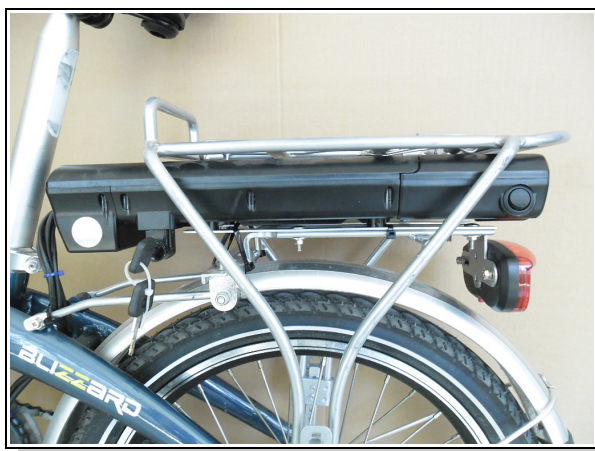
Position des 12,5 Ah Akkus nach der Umrüstung des Gepäckträgers
