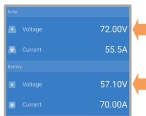
2. Se ciò non fosse possibile, misurare le tensioni batteria e FV nei morsetti del caricatterie solare con un multimetro.
