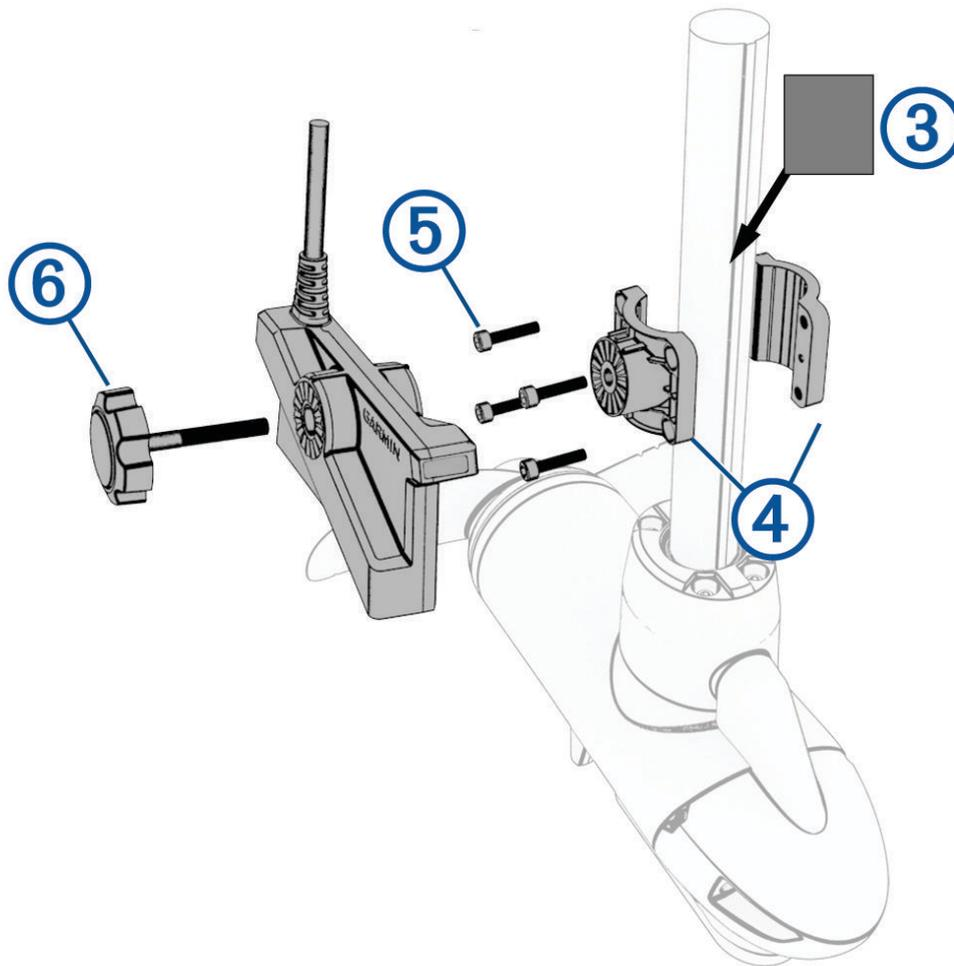
**NOTA:** il rivestimento in gomma non è necessario quando si installa il trasduttore su un trolling motor con un diametro dell'albero superiore a 25 mm (1 poll.).
