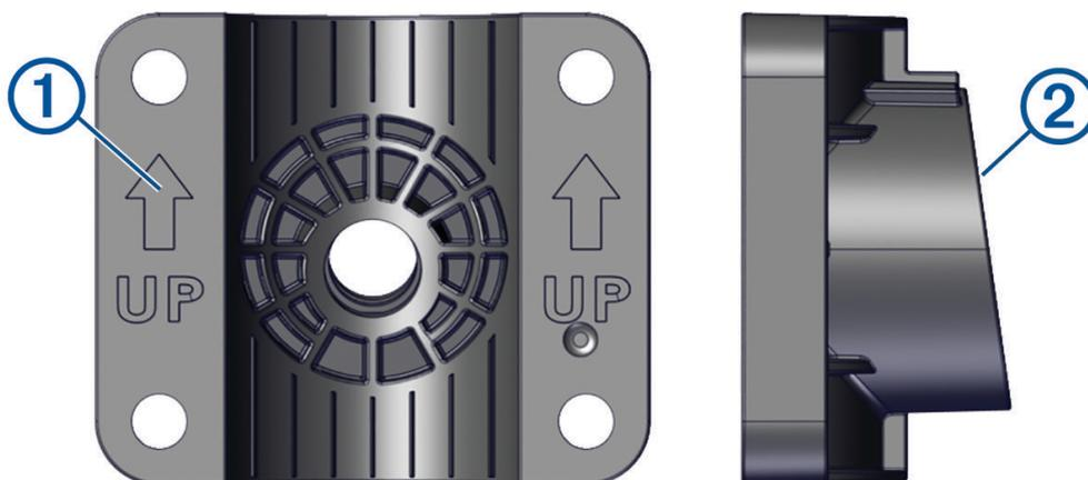
**NOTA:** la staffa dell'albero del trolling motor ha un'inclinazione di 8 gradi che consente di ridurre l'interferenza della barra del trolling motor con il fascio del trasduttore.
