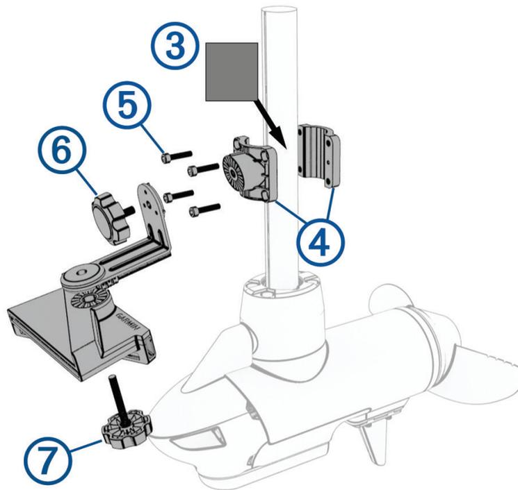
**NOTA:** il rivestimento in gomma non è necessario quando si installa il trasduttore su un trolling motor con un diametro dell'albero superiore a 25 mm (1 poll.).
