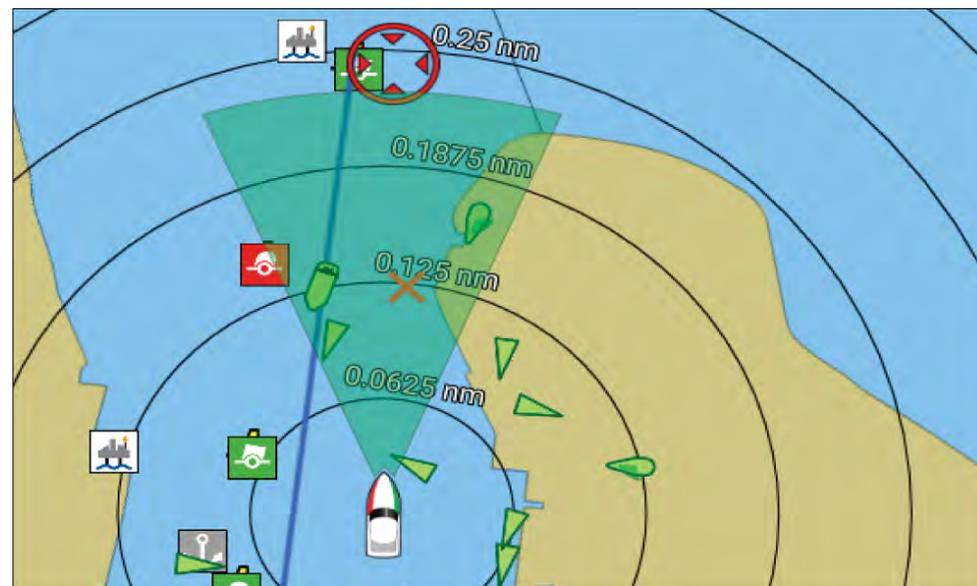
Le cône FOV peut être activé/désactivé dans les paramètres de l'application Carte : [*Menu > Paramètres > Couches*].
