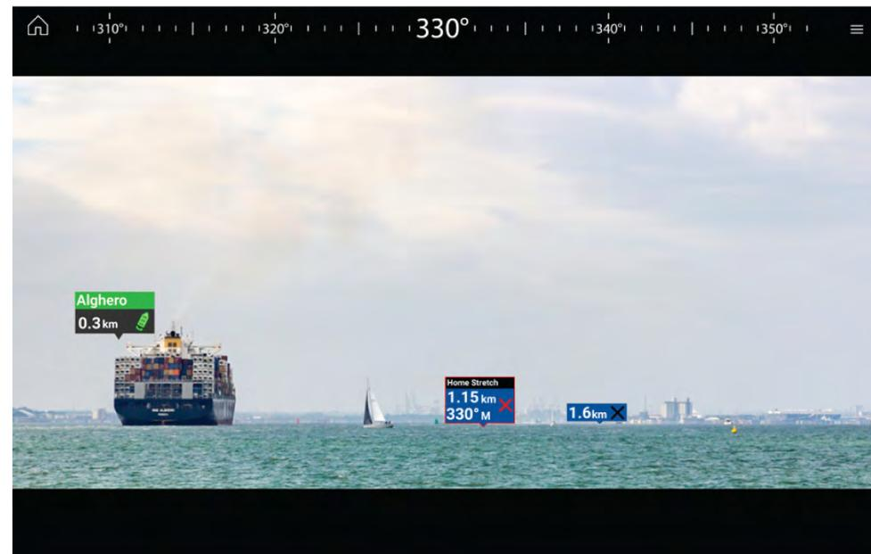
La fonctionnalité de [réalité augmentée] superpose des couches d'informations numériques directement sur le flux vidéo de l'application Vidéo. Les objets provenant de la cartographie sont utilisés pour générer des images (indicateurs) et du texte informatif sur l'application Réalité Augmentée. Quand elle est correctement étalonée, la fonction ClearCruise™ superpose des indicateurs précis et automatiquement actualisés sur la vidéo de la caméra.
