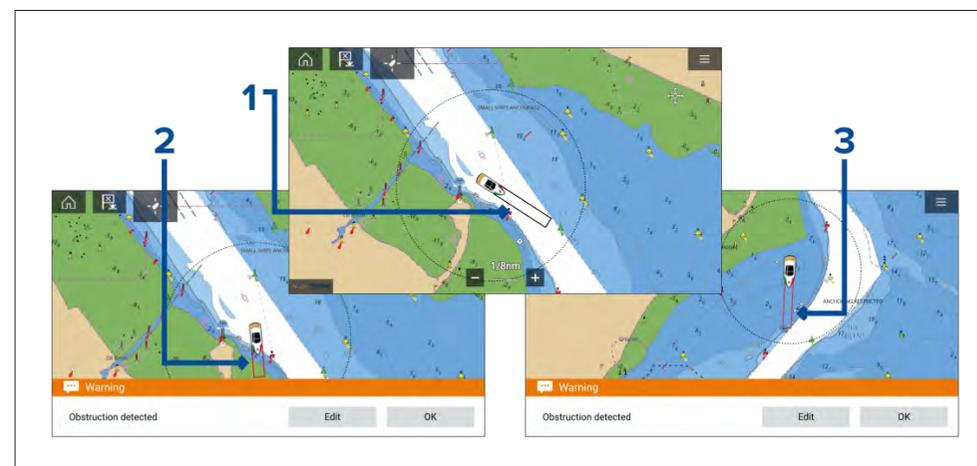
1. Si aucun obstacle n'est présent, le contour de la zone de détection reste en noir jusqu'à ce qu'un obstacle soit détecté.
