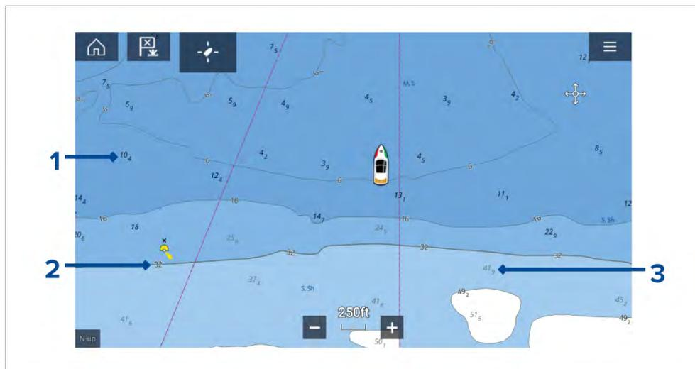
1. Sondages de profondeur renforcés — Les sondages de profondeur qui s'affichent en caractères renforcés correspondent à des profondeurs inférieures aux valeurs (isobathes) de sécurité spécifiées.
