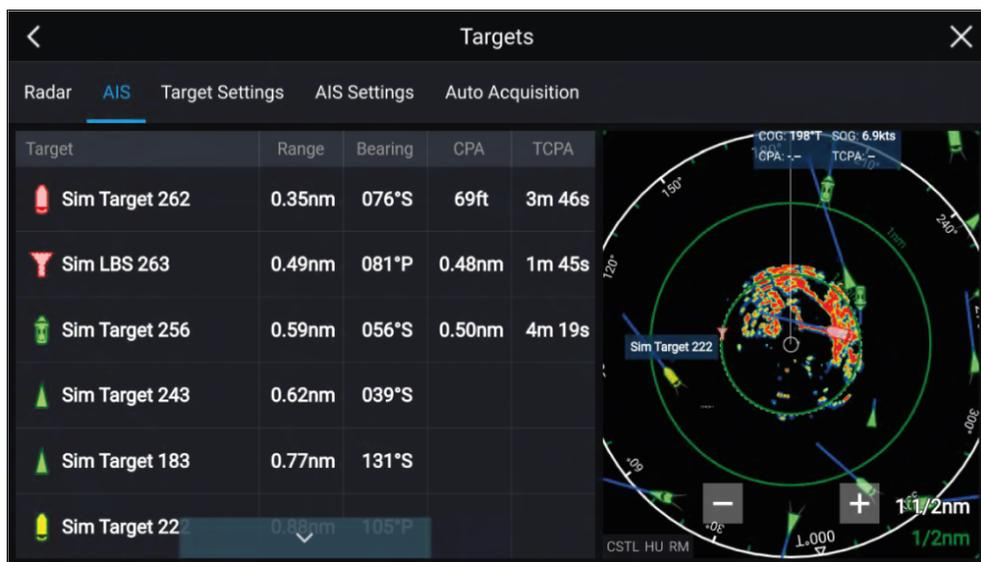
La liste indique : le nom de la cible, la distance et le relèvement (depuis votre navire). Le cas échéant, les valeurs du CPA (point de rapprochement maximum) et du TCPA ( Délai d'arrivée au point de rapprochement maximum) sont également indiquées.
