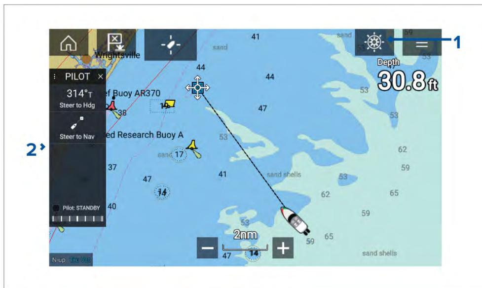
1. *[Icône Pilote]* — La *[Commande du pilote]* étant activée, l'icône Pilote est affichée sur l'écran ; la sélection de cette icône a pour effet d'afficher la barre latérale du pilote. Quand le pilote automatique est engagé, l'icône de pilote est remplacée par l'icône Désengager pilote.
