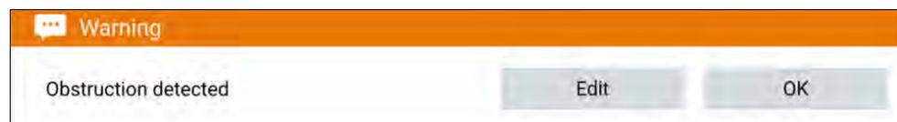
Quand l'alarme d'obstacle se déclenche, une notification d'alarme s'affiche et un bip sonore retentit sur le MFD. Dans la fenêtre de notification à l'écran, vous pouvez acquiescer l'alarme en sélectionnant *[OK]*, ou modifier les paramètres d'alarme en choisissant *[Modifier]*.
