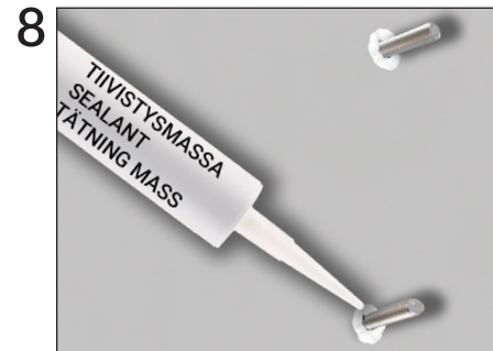
EN Inside the boat apply sealant around the bolts and place the reinforcement plate on top of the bolts. IT All'interno dell'imbarcazione applicare il sigillante attorno ai bulloni e posizionare la piastra di rinforzo sopra i bulloni.
