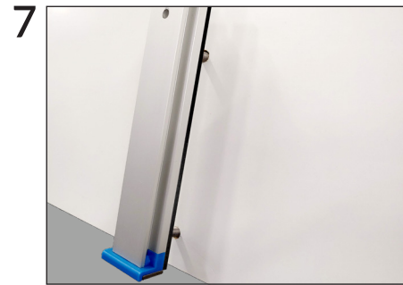
EN Place the rubber mat and the rail to the transom. IT Posizionare il tappetino in gomma e la rotaia sullo specchio di poppa.
