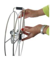
5. Stecken Sie die Achse durch die Ankergurtbandrolle. Achten Sie hierbei auf die Arretierungslöcher, um den richtigen Winkel des Führungsarms einzustellen.
