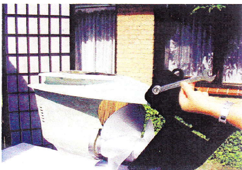
7. Die Bolzen so fest anziehen dass das Ruderblatt noch leicht hochklappen kann.
