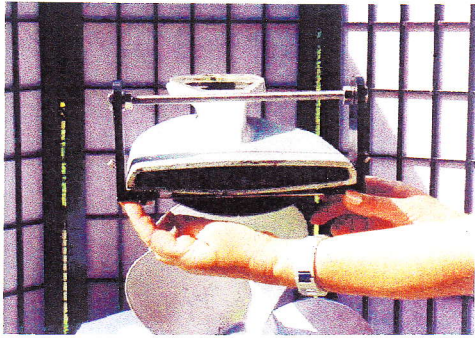
1. Vormontierte Halterung ueber die Kavitations Platte schieben und fest gegen die Unterseite druucken. Inbusschrauben e
