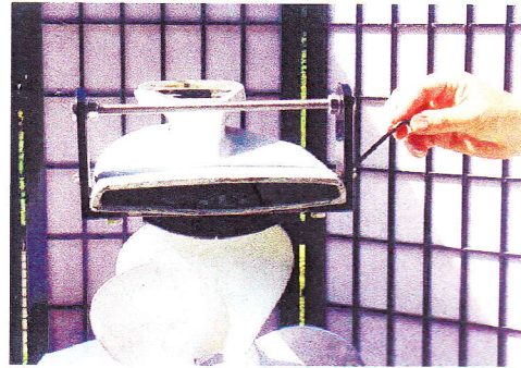
2. Inbusschrauben mit mitgelieferte Nutlock einfetten, wieder zurueckmontieren und gleichmaessig fest anziehen.
