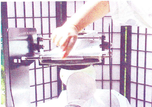
11. Gewindestange mit Kunststoffschlauch oben im Blatt montieren und beachten dass die Blaetter parallel montiert werden
